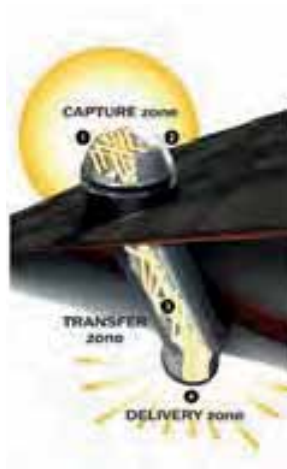
Figure 3 - A roof mounted solar tube Şekil 3 - Çatıya monte güneş borusu
